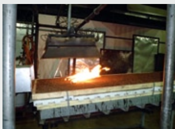
Прошла примерно одна минута после размещения двух зажигательных предметов. Огонь зажегся от потока воздуха, направленного вентилятором, достигал до 50 см в длину. (На фотографии представлен образец системы озеленения с Floraset® FS 50).
