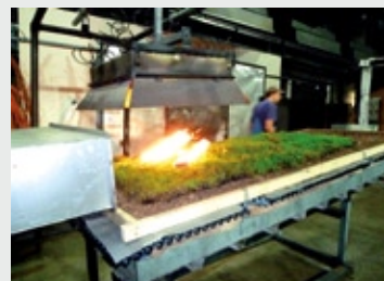
Даже с растительным слоем система озеленения кровель прошла испытания. Зажигательный предмет погас по истечении 12 минут, но растения не воспламенились.
