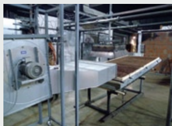
Опытное оборудование для испытаний по Процедуре 3. Вентилятор и нагреватель. Система озеленения кровель размером 3 x 1,2 м, первоначально не включающая в себя растительный слой.
