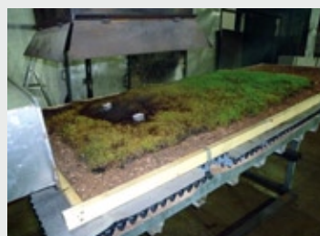
После того, как зажигательные предметы были потушены, тепловое облучение продолжалось еще на протяжении 30 минут — до завершения опыта. Это привело к высыханию участка растительности диаметром примерно 80 см.
