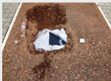
Не смотря на то, что после окончания испытаний температура на поверхности субстрата составила около 300 °С, не было обнаружено никаких последствий от пожара ни на системном фильтре, ни на дренажном элементе. (На фотографии представлен образец системы озеленения с Floradrain® FD 25).
