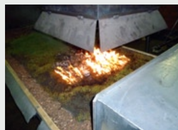
После окончания официальной части опыта на высохший участок с внешней стороны направили открытое пламя. Огонь сам погас через 2 минуты. Этот участок растительного мата все еще оставался «влажным» и не пострадавшим.
