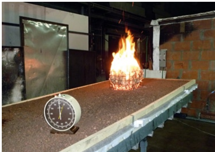
Прежде всего, согласно стандарту DIN 4102-7 был проведен опыт противопожарной безопасности по Процедуре 1 DIN EN 1187. Система озеленения кровель не пострадала.
